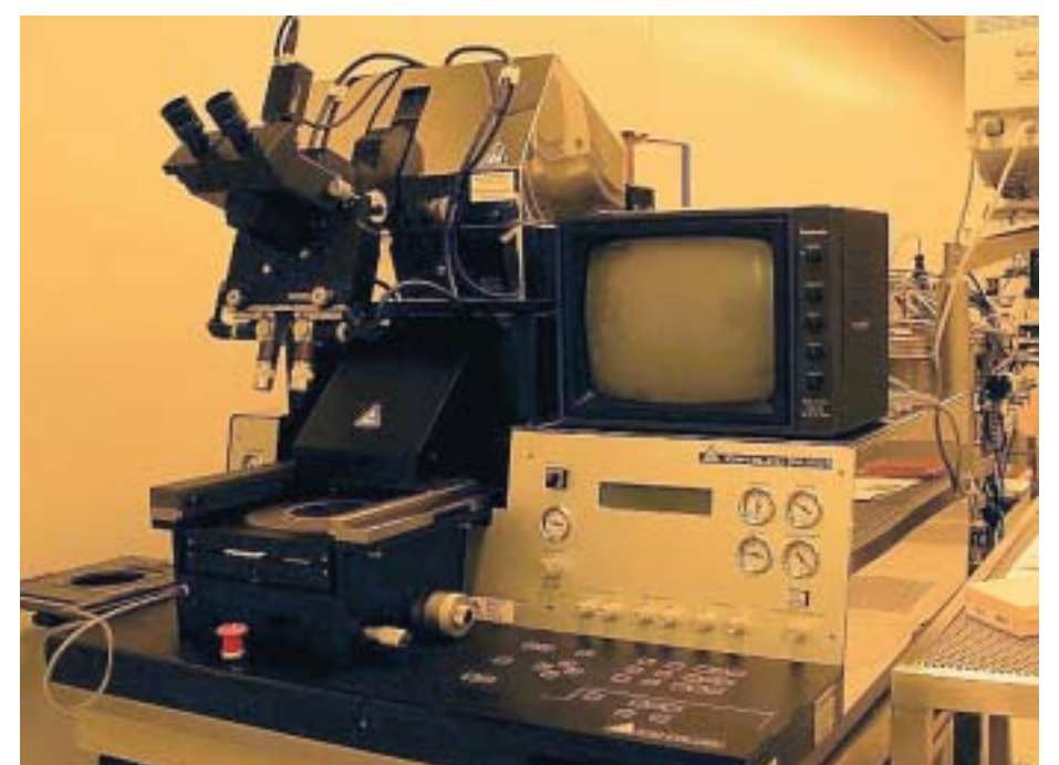
Die korrekte Bedienung solcher Maschinen – hier ein Maskaligner aus dem Reinraum – wird per Computersimulation eingeübt. Foto: pm/th
